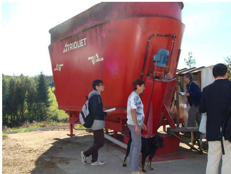
写真 4-7 醗酵槽に原料穀物を送り込むタンク
